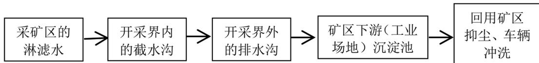
图5 淋滤水的处理工艺流程
